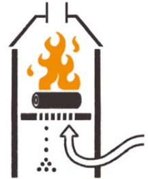
Grillkamin mit freiem Rauchabzug
